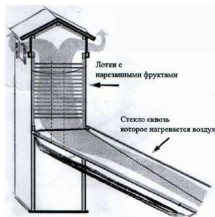
Рис.1. Схема дегидратора с солнечной панелью.
